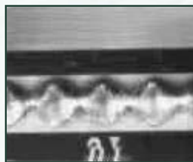
Lötstelle mit Brückenbildung (SnCu0,7)
